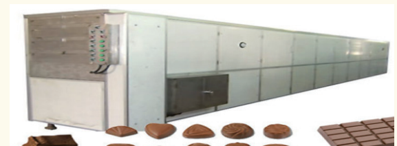
5. MLD COOLING TUUNEL
